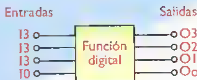
Figura 13.17. Estructura general de un circuito integrado digital
